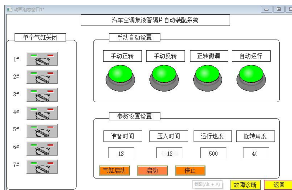
图 3-6 空调打片机控制系统
