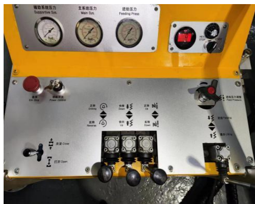
图 3-7 电动液压钻机自动控制系统
