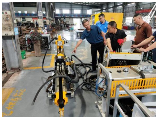
图 3-7 电动液压钻机自动控制系统
